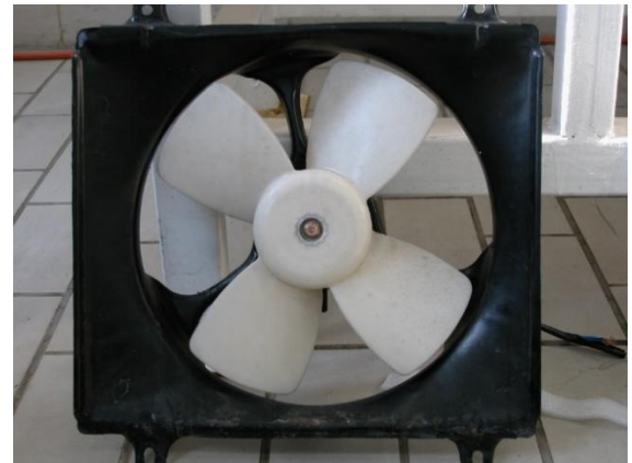
(b) Old radiator fan
